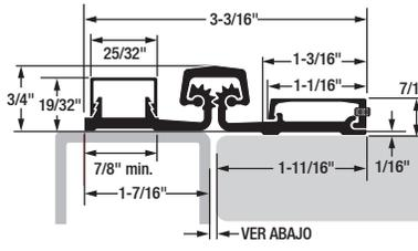
El modelo SL21 requiere que el reposicionamiento del (de los) cierrapuertas superior(es) coincida con el centro giratorio de giro total de la bisagra. De lo contrario, la puerta no podrá abrir más de 70 grados. Fije la cubierta de hoja de la bisagra antes de instalar el (los) cierrapuertas.
