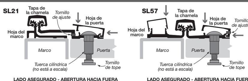
**NOTA:** Para las aplicaciones con apertura hacia dentro, invierta la posición de la tuerca cilíndrica y del tornillo de tope para que del tornillo de tope esté en el lado asegurado de la puerta.
