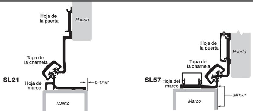
Fig. 3 Instalación de la cubierta de la hoja
